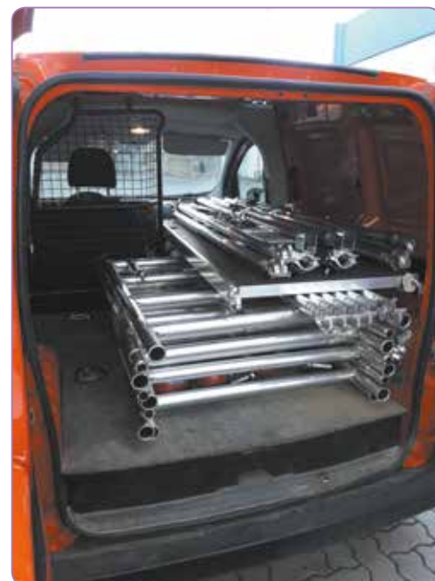
Esempio di ponteggio trasportato su minifurgone
