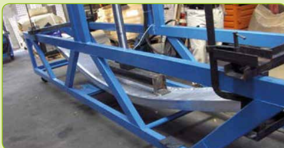
Rampa sottoposta a rottura.
