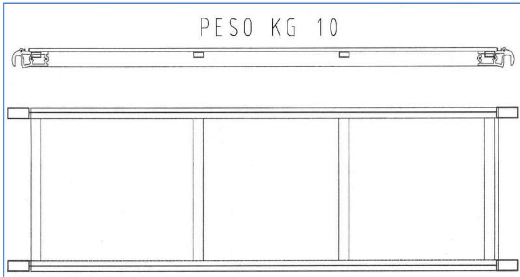
**ELEMENTO FINALE:** è costituito da due tubi portanti di sezione rotonda e da tre gradini di sezione ovale; è zincato argento, compone, congiuntamente al set finale, la campata finale, ovvero la campata più elevata, quella su cui si intende lavorare.
