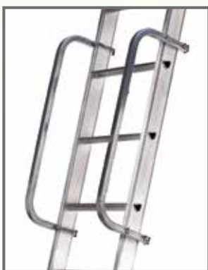
Corrimano di uscita Facilmente applicabile. Rende maggiormente sicuro lo sbarco sul piano. È realizzato in tubo quadro di alluminio a spigolo arrotondato da mm 25x25 da cm 70 distanza dal montante cm 21 cod. A50CORR
