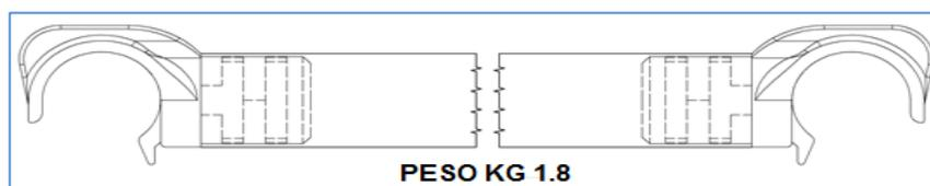
**STAFFONE:** è costituito da un tubo di sezione tonda, alla cui estremità inferiore è inserito un tappo antiscivolo, da uno di sezione rettangolare e da un sistema di giunti di fissaggio, il tutto assemblato per mezzo di viti e dadi; consente, nei modi d'uso previsti dal presente manuale, di dare ulteriore stabilità alla struttura (dis. 7)
