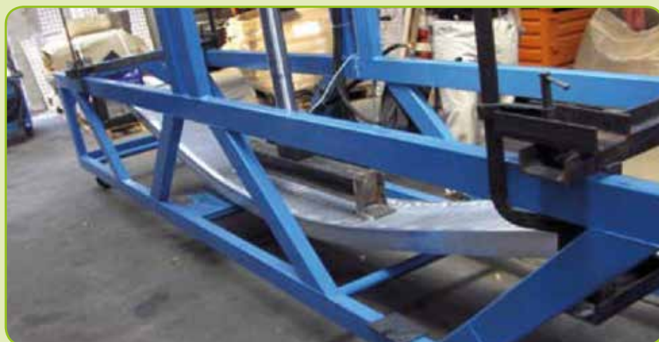
Rampa sottoposta a rottura.
