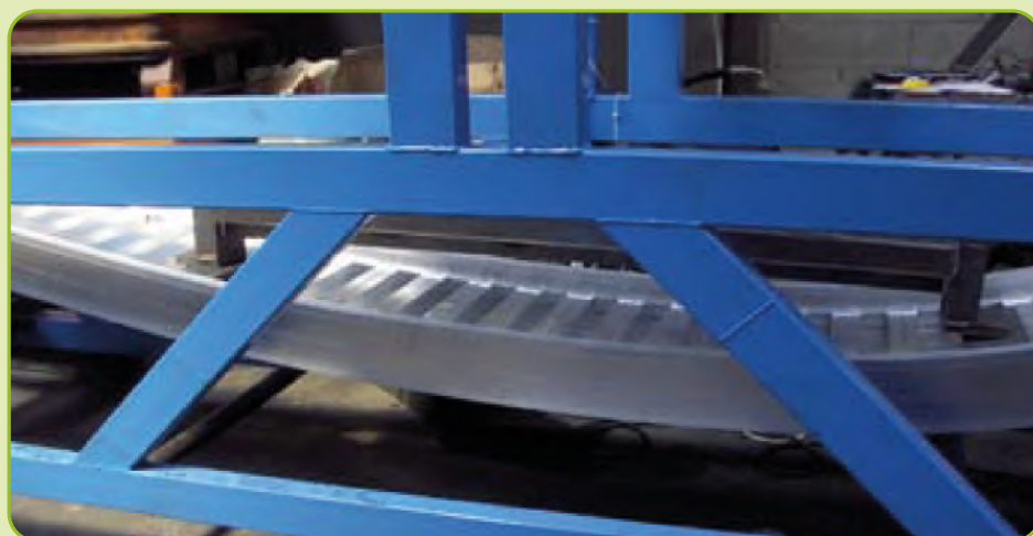
Rampa sottoposta a rottura.
