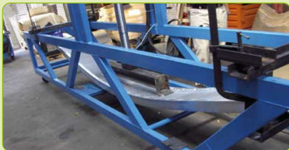
Rampa sottoposta a rottura.
