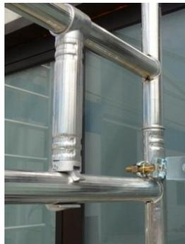
Per montare le diagonali occorre agire sul dispositivo di innesto a pressione: spingendo verso il corpo dello stesso, si apre preparandosi all'inserimento nel tubo; giunto in posizione corretta automaticamente si blocca. Le posizioni delle diagonali sono visibili nei disegni "configurazione" e riassunte nella tabella sottostante. Le diagonali devono essere montate in modo contrapposto ovvero inverso tra un lato longitudinale e l'altro.
