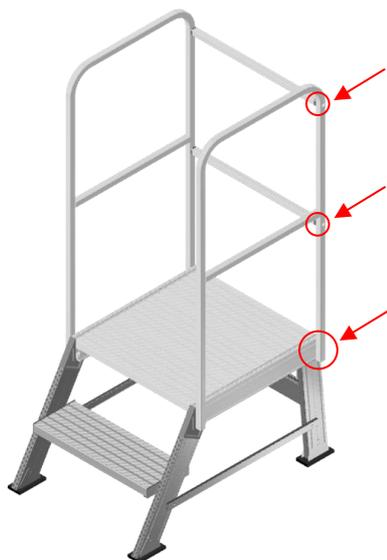
Per montare il parapetto con sbarco laterale destro o sinistro, fissare alla passerella le parti 1 e 3, facendo passare le viti Halfen in dotazione attraverso i fori posti nella parte bassa dei parapetti laterali, inserendole nella canalina della pedana. In seguito, montare le aste frontali giuntandole alle parti 1 e 3 con le apposite viti.
