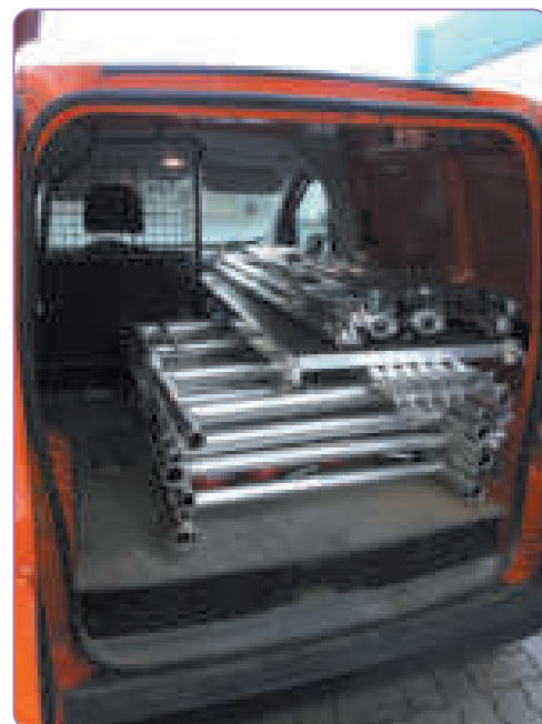
Esempio di ponteggio trasportato su minifurgone
