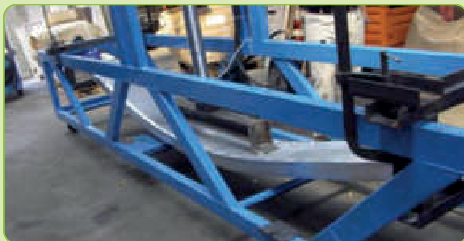
Rampa sottoposta a rottura.
