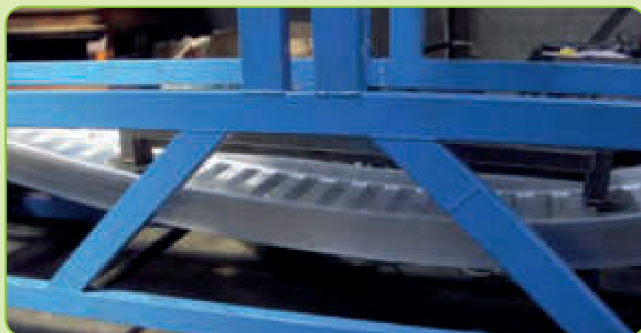
Rampa sottoposta a rottura.
