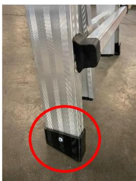
2. Eseguire un foro da diametro 10 mm al centro del montante ad una altezza di 100 mm.
