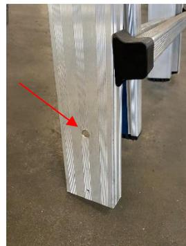
3. Inserire nel montante l'accessorio per dislivelli, facendo combaciare la vite con il foro eseguito precedentemente e avvitare il volantino.
