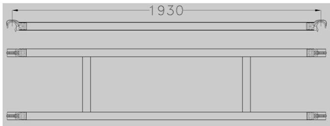
**GIUNTO PER ELEMENTI:** è costituito da un tubo diam. 50 mm inserito nel primo gradino alto degli elementi tramite fusione alluminio. Nell'altra estremità è presente un dispositivo di aggancio rapido per congiungersi all'elemento superiore
