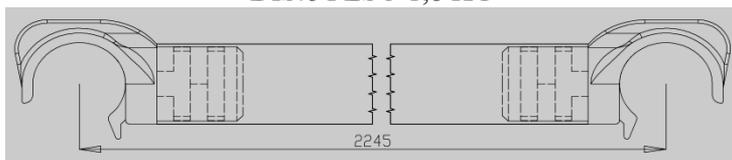
**STAFFONE:** è costituito da un tubo di sezione tonda, alla cui estremità inferiore è inserito un tappo antiscivolo, da uno di sezione rettangolare e da un sistema di giunti di fissaggio, il tutto assemblato per mezzo di viti e dadi; consente, nei modi d'uso previsti dal presente manuale, di dare ulteriore stabilità alla struttura.
