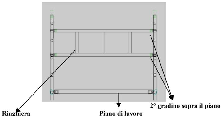
La parte inferiore della ringhiera deve poggiare sopra il secondo gradino superiore rispetto al piano di lavoro, con i ganci rivolti dall'interno verso l'esterno, longitudinalmente, da entrambi i lati del trabattello.
