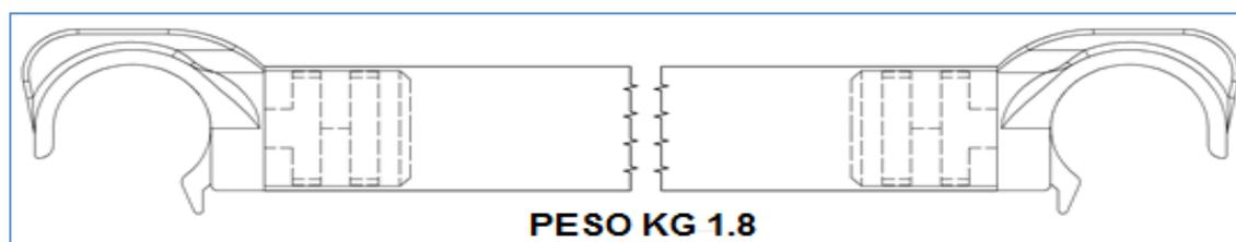
**STAFFONE:** è costituito da un tubo di sezione tonda, alla cui estremità inferiore è inserito un tappo antiscivolo, da uno di sezione rettangolare e da un sistema di giunti di fissaggio, il tutto assemblato per mezzo di viti e dadi; consente, nei modi d'uso previsti dal presente manuale, di dare ulteriore stabilità alla struttura
