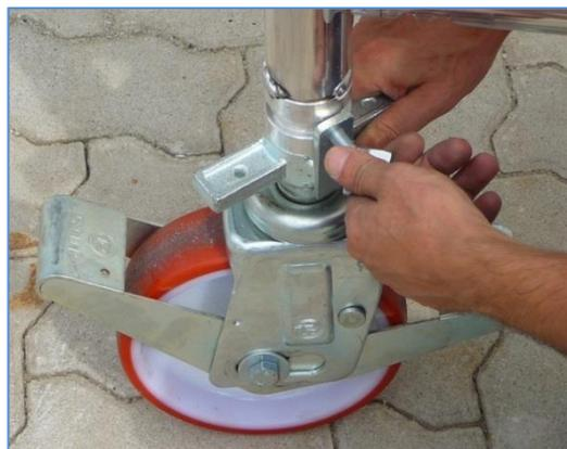
Questa operazione consente il corretto livellamento del ponteggio, da verificare sempre, comunque, con strumentazione idonea. Sbloccare la vite a farfalla per consentire la regolazione della ruota (avvitare o svitare la ghiera). Raggiunto il livellamento desiderato, avvitare nuovamente la vite a farfalla per impedire l'accidentale rotazione del perno a vite che regola l'altezza della ruota. Verificare la perfetta verticalità della sezione con
