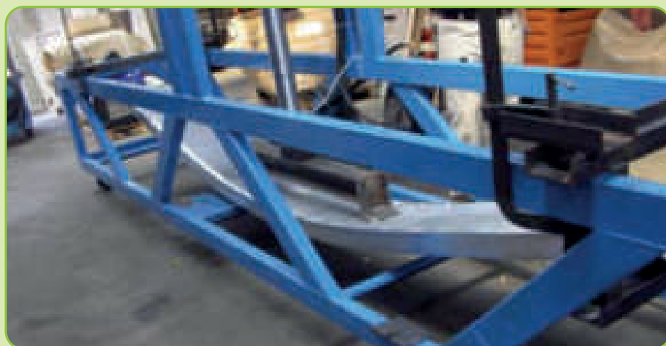
Rampa sottoposta a rottura.
