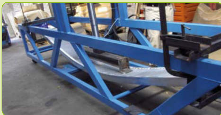
Rampa sottoposta a rottura.
