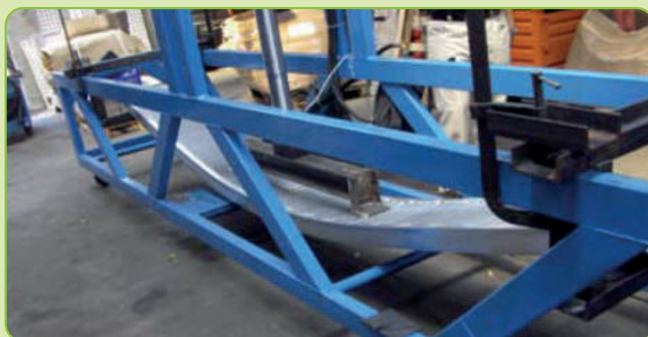
Rampa sottoposta a rottura.
