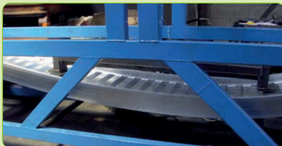
Rampa sottoposta a rottura.
